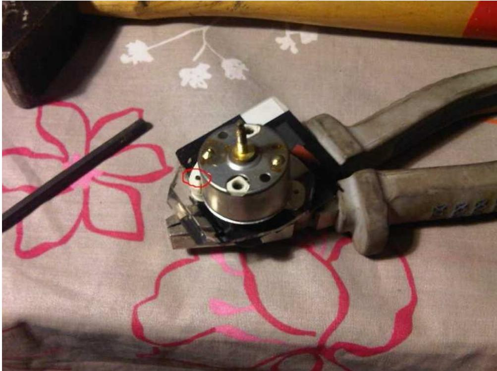
De l'autre côté, le dégager ensuite complètement avec la pince en faisant tourner le rivet (il est vrillé). Positionner le nouveau fdc avec des petits points de colle. Faire coïncider les trous. Remettre les rivets avec la multi-prise, ça va tout seul.
